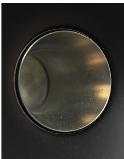
Duży faliowód w IsoFlare Classiców X i XII prowadzi promieniowanie od przetwornika wysokotonowego zbudowanego na wzór przetworników kompresyjnych; jego 75-mm membrana jest znacznie większa od wlotu faliowodu, zasłoniętego siateczką.
