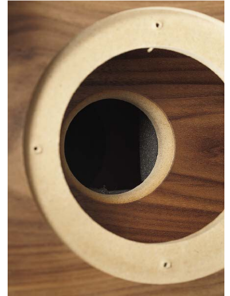
Na pierwszym planie otwór po odkręceniu dekla ze stożkiem (normalnie jest więc zaślepiony), głębiej – przegroda z otworem, jeszcze dalej (wyżej) – kolejna przegroda będąca już dnem komory głośnika, w której zainstalowano tunel. Taki schemat zastosowano też w większych Classic X i Classic XII .
